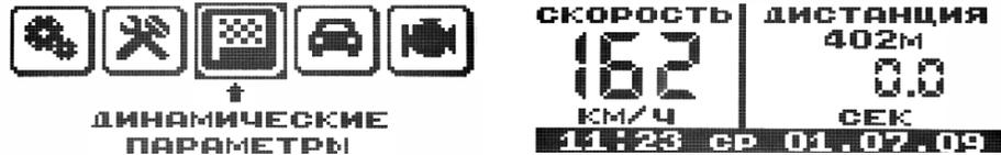
Переключение в группу производится из основного меню БК нажатием на RESET или автоматически по истечению 5 сек. В этом режиме БК отображает функции:
